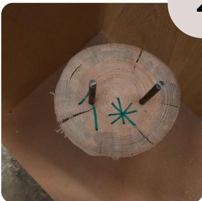
So sieht der Stamm von oben aus. Achten Sie immer darauf, dass die Nummer und das Symbol gut sichtbar sind. Jedes Mal, wenn Sie einen weiteren Stamm oder Regalboden befestigen, müssen die Zeichen auf dem obersten Regalelement sichtbar sein.
