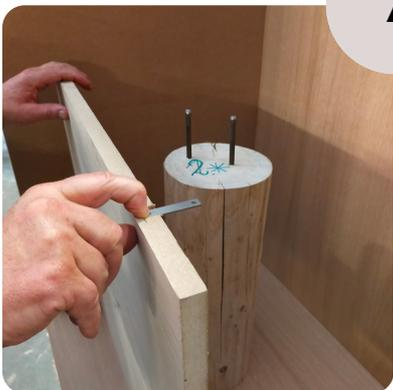
Legen Sie die Platte in die Aussparung des Regalbodens und verschrauben Sie sie mit diesem.
